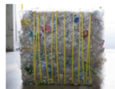
PETボトル成型品 1個:1.1×1.1×1.1m,約200kg 13年間で79,249個
