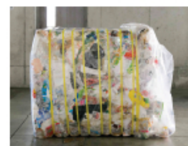
容器包装プラスチック成型品 1個:1.1×1.1×1.1m,約280kg 13年間で180,108個
